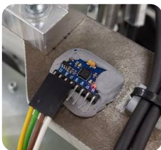
Gyroskop Sensor mit industrieller Modelliermasse
